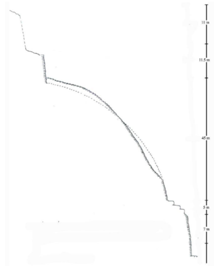
ස්තූපයේ පාදමේ සිට කොත්කැරැල්ල දක්වා මිනුම් සහ දළ හැඩය සහිත හරස් කැපුම (පරිමාණයට නොවේ)
